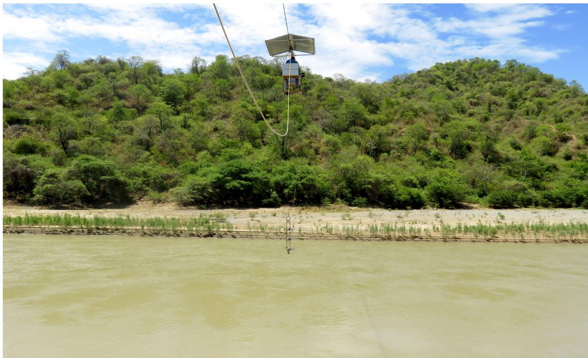
Muestreo de sedimentos en suspensión con el muestreador triple.
