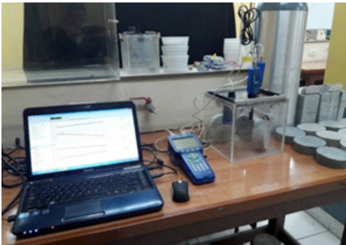
Equipo para observar la carbonatación acelerada de pastas de cemento, morteros y concreto. (LEM-FIC-UNI).
