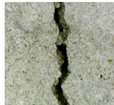
Figura N° 2: Captura de imagen de fisuras tomada con el microscopio 60X. (Fuente: Propia)
