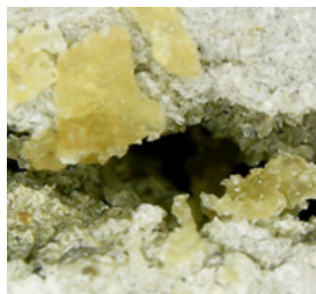
Figura N° 5: Desarrollo del autocurado de las fisuras del concreto observadas a los 7 y 14 días.
