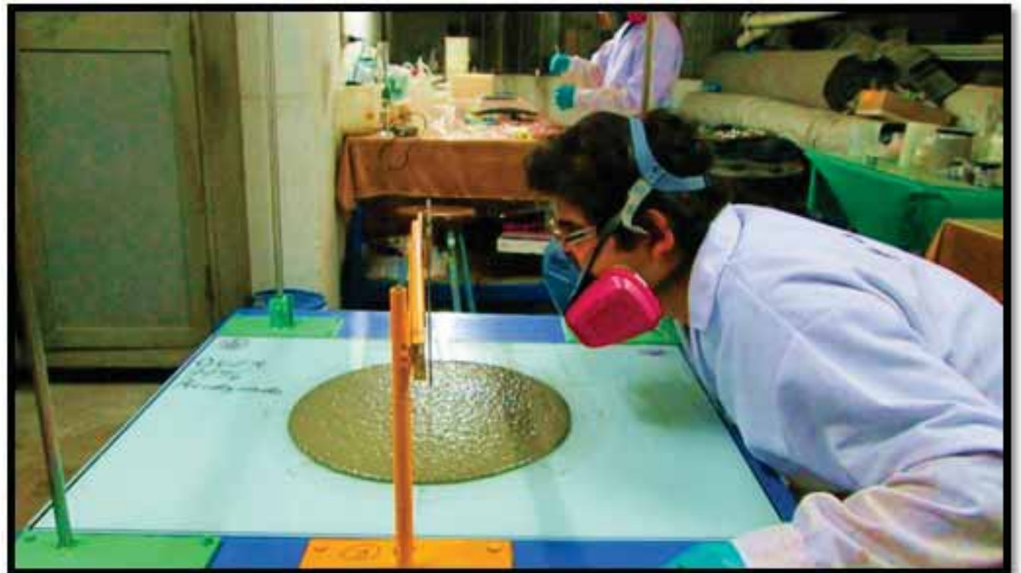
Medición del asentamiento (slump) de una muestra de relave minero (overflow) a una determinada concentración gravimétrica de sólidos
